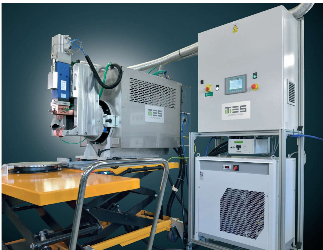
Zařízení k tepelnému krimpování vývodů HOT CRIMPING od TES VSETÍN a.s.
